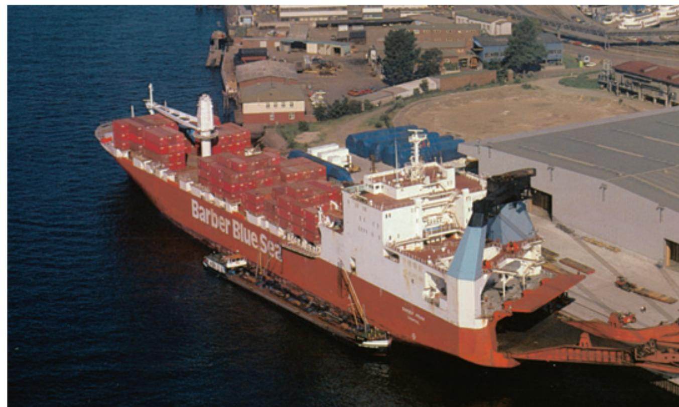
Ein Roll-on/Roll-off-Schiff mit geöffneter Heckklappe
